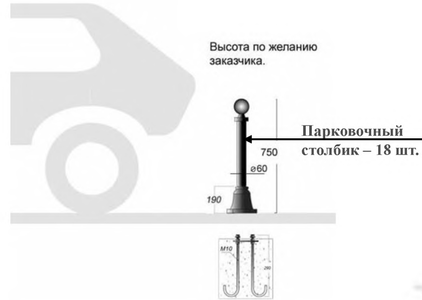
Схема установки парковочного столбика.
